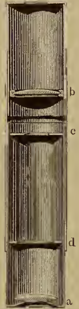
Abb. 1. Mikroskop aus zwei Sammellinsen 1) .
